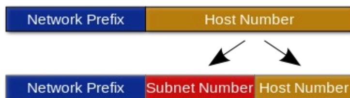
Il subnet number prende in prestito alcuni bit(*borrowed*) dalla parte host dell'indirizzo di rete.
